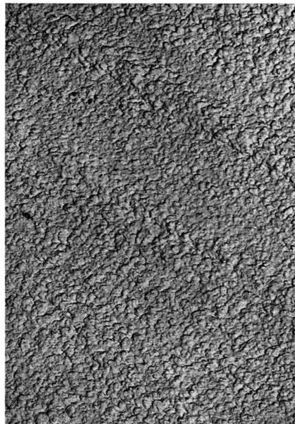
Abb. 6. Stereoaufnahme der Kupferoxydoberfläche nach 1 min bei 300 °C (1 \mu =8 mm).
